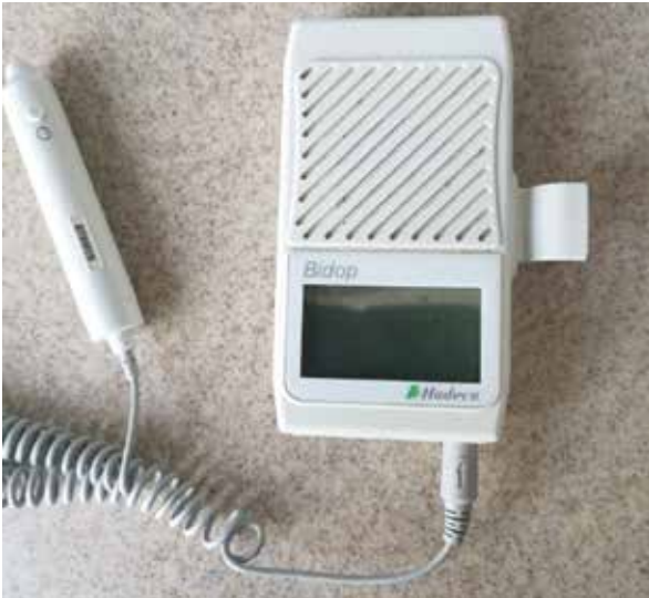
Rycina 4. Doppler ABI. Zestaw do pomiaru współczynnika kostkowo-ramiennego
